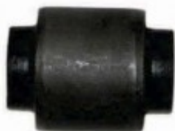
GR 732 Nº Original 52.395-SR0-A01 Buchas Superiores do Braço Auxiliar Lado Facão Traseiro Civic 92 / ... / 00
