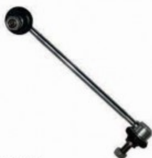
GR 553 Nº Original 31351091856 Bieleta Dianteira Esquerda Série 5 95 / ...
