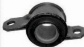
GR 920 Nº Original 132.075.2080 Bucha da Suspensão Traseira Ducato / Boxer / Jumper
