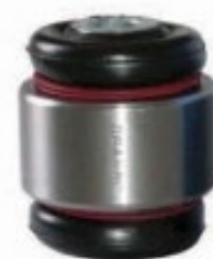
GR 285 Nº Original 90.496.700 Bucha Art. da Suspensão Braço Traseiro Vectra 96 / ... / 05
