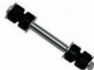
GR 220 Nº Original 11.072.881 Bieleta Dianteira Chevette
