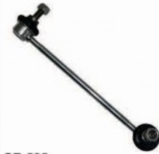
GR 525 Nº Original A168.320.10.89 Bieleta Dianteira Classe A
