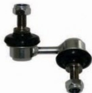
GR 720 Nº Original 51.320-S5A-003 Bieleta Dianteira Direita Civic 01 / ... / 05
