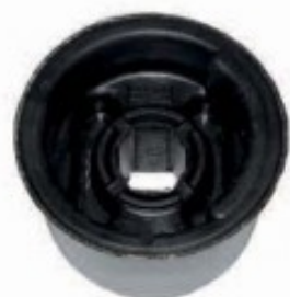
GR 857 Nº Original 1K04.071.83A Bucha da Suspensão Dianteira Fox
