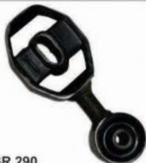
GR 290 Nº Original 90.496.942 Tirante do Motor Dianteiro Vectra 96 / ... / 05
