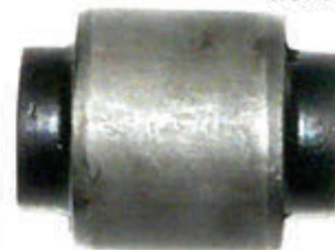
GR 732 OEM N° 52.395-SR0-A01 Bucha Superior do Braço Auxiliar Lado Facão Traseiro Civic 1992 / ... / 2000
