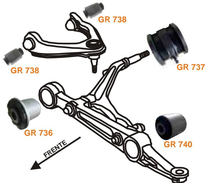
ESQUEMA DE MONTAGEM DA SUSPENSÃO TRASEIRA.
